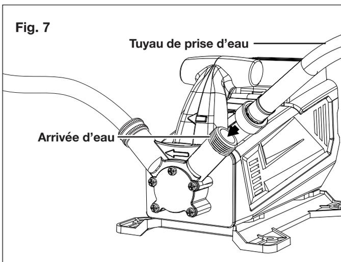
**REMARQUE :** avant d'allumer la pompe, assurez-vous que les branchements des tuyaux sont serrés. Un branchement qui fuit réduit considérablement la puissance d'aspiration et le rendement de la pompe.
