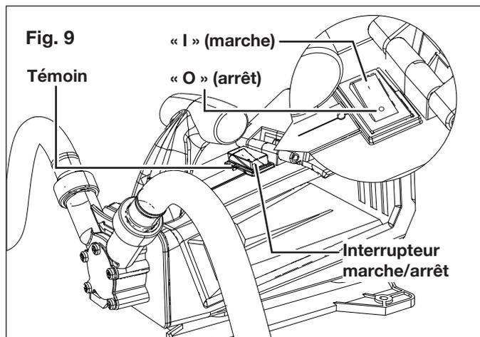
**REMARQUE :** le témoin est utilisé pour indiquer le statut de la pompe en marche. Quand le témoin est rouge, la pompe fonctionne normalement. Quand le témoin clignote, il indique que la pompe est en surchauffe. Arrêtez la pompe et laissez-la se refroidir avant de la redémarrer. La pompe est également équipée d'une protection contre la surchauffe qui arrête automatiquement la pompe lorsqu'elle tourne à sec.
