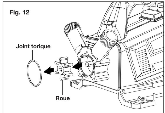
4. Remplacez la roue et le joint torique neufs. Lors de l'assemblage de la roue, veillez à bien aligner l'axe avec le trou médian de la roue et enfoncez la roue aussi loin que possible dans la pompe.
