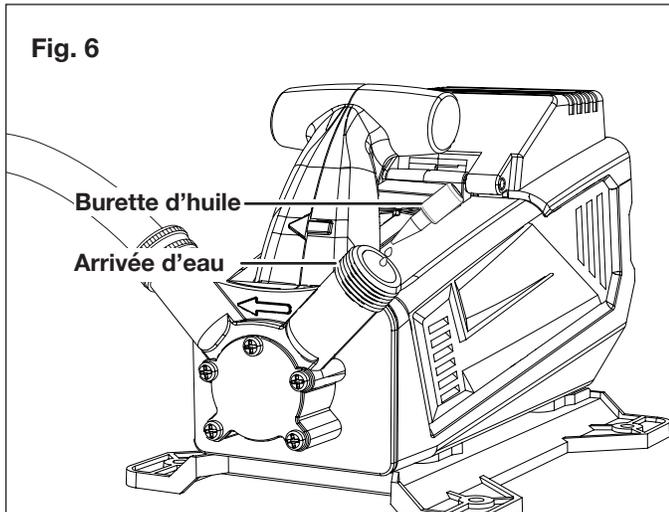
4. Branchez l'extrémité femelle du tuyau de prise d'eau fourni dans l'arrivée d'eau. Vissez pour attacher (Fig. 7).
